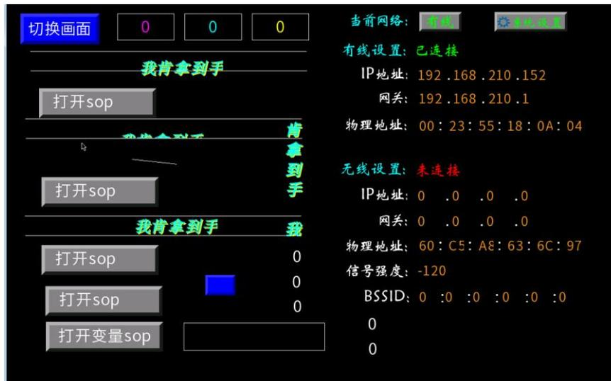
此时，手机端可以反应 HMI 端的屏幕变化，同时也可以通过对手机屏幕的操作来控制 HMI
