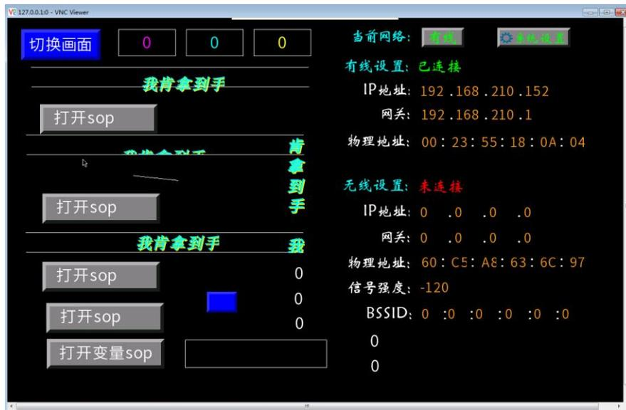
此时，PC 端可以迅速反应 HMI 端的屏幕变化，同时也可以通过对 PC 端的操作来控制 HMI
